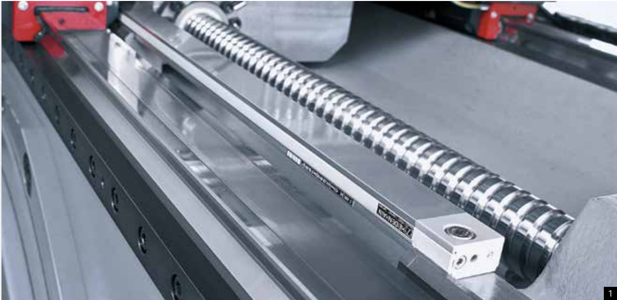
1: Digitale Antriebe, Linearführungen und direkte Messsysteme (Option) für höchste Genauigkeit 2: Starrer Tisch 3: Schwenkrundtisch mit digitalen Antrieben 4: Schwenkrundtisch zur 5-Achs-Simultanbearbeitung
